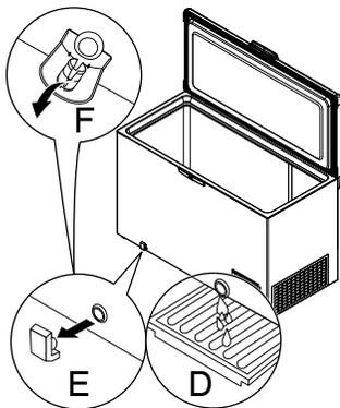
4. Placer des plats d'eau chaude dans le congélateur et laisser le couvercle ouvert pour accélérer le dégivrage. Diriger le flux d'air produit par un ventilateur dans le congélateur aidera aussi. Ne pas placer le ventilateur ou tout autre appareil électrique dans le congélateur.
