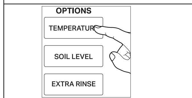
Una vez que elija un ciclo, seleccione la temperatura de lavado deseada presionando repetidamente el botón de Temperature (Temperatura) para seleccionar el ajuste apropiado según su carga. Todos los enjuagues usan agua fría del grifo.
