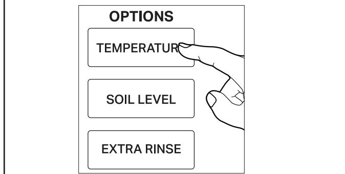
Après avoir sélectionné un programme, sélectionner la température de lavage désirée en appuyant à plusieurs reprises sur le bouton de température au réglage adapté à la charge à laver. Tous les rinçages se font à la température de l'eau froide du robinet.
