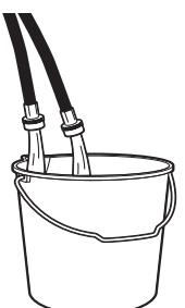
Cerciórese de que las mangueras de agua caliente y de agua fría estén conectadas a las llaves correctas. La lavadora no funciona si no están conectadas las dos mangueras.
