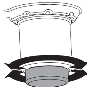
El aparato debe colocarse en el suelo de forma nivelada para garantizar su estabilidad:
