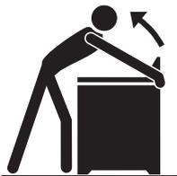
Pour vérifier si le support anti-basculement est correctement installé, utilisez les deux bras et saisissez le bord arrière de la cuisinière. Essayez avec précaution d'incliner la cuisinière vers l'avant. Lorsqu'elle est correctement installée, la cuisinière ne doit pas s'incliner vers l'avant.
