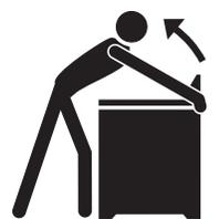
Para comprobar que el soporte antivuelco esté instalado correctamente, utilice los dos brazos y sujete el borde trasero de la estufa. Intente inclinar la estufa hacia delante con mucho cuidado. Si está correctamente instalada, la estufa no debería inclinarse hacia delante.
