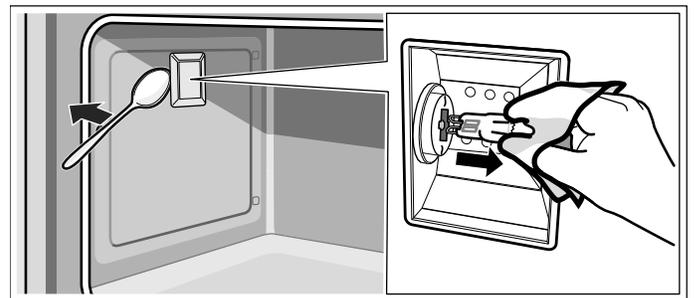
7. Remplacez l'ampoule du four par une ampoule du même type.
