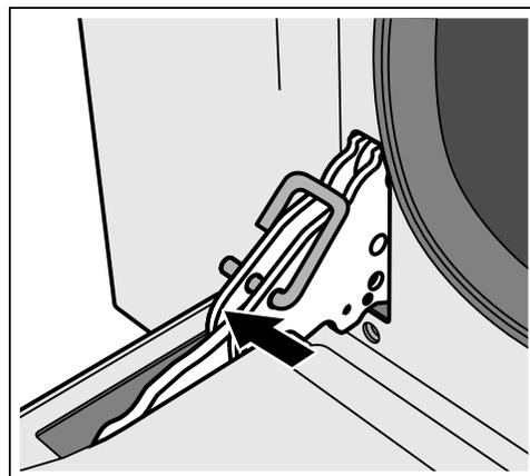
3. Fermez la porte du four jusqu'à ce qu'elle s'enclenche sur les leviers d'arrêt des charnières tout en verrouillant ces dernières selon l'angle correct pour le retrait de la porte. La porte peut être retirée lorsqu'elle est soulevée d'environ 8 pouces (203 mm) de la position ouverte. La tension des charnières à ressort est ainsi relâchée, ce qui permet à la porte de s'ouvrir facilement.
