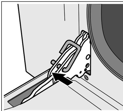
3. Enlevez la vitre intérieure en tirant doucement la partie arrière vers le haut, tout en suivant le mouvement indiqué par les flèches (1). De cette façon, les 2 premières broches attachées à l'arrière de la vitre se détachent de leurs logements dans la porte du four. Ensuite, poussez légèrement la vitre vers le compartiment de cuisson et tirez-la vers le haut (2). De cette façon, les 2 autres broches attachées à l'avant de la vitre se détachent de leurs logements de la porte du four.
