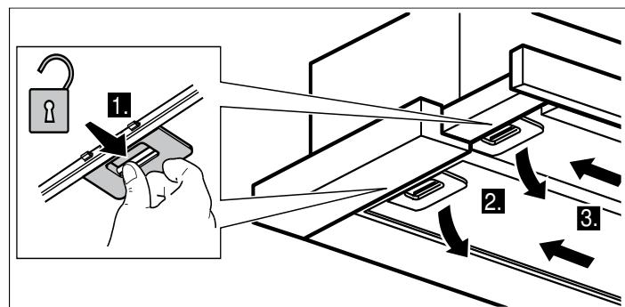
**Remarque :** La graisse peut s'accumuler dans le bas du filtre à graisse en métal. Tenir le filtre à graisse en métal à l'horizontale pour éviter tout égouttement de graisse.
