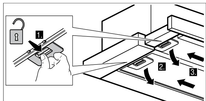
**Nota:** La grasa puede acumularse en la parte inferior del filtro de metal antigrasa. Sujetar el filtro de metal antigrasa en posición horizontal para evitar que gotee grasa.
