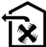
L'air aspiré est débarrassé des impuretés par les filtres à graisse, transite par un conduit puis gagne l'extérieur.
