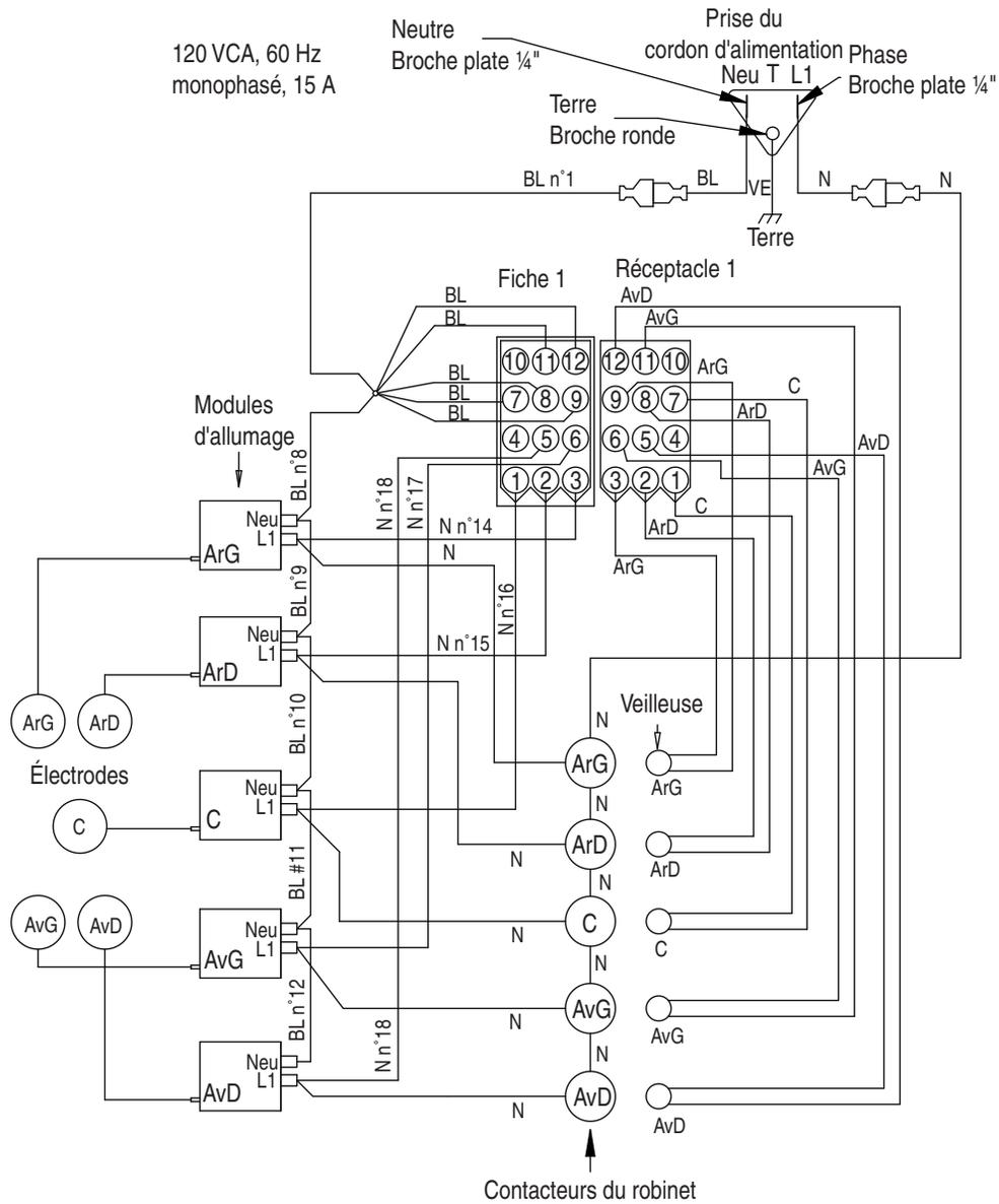
**REMARQUE :** Le circuit électrique est fermé dès que le bouton est enfoncé et tourné dans le sens anti-horaire entre 0 et 210° depuis la position d'arrêt.
