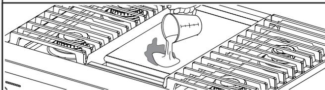
À l'aide d'une tasse à mesurer, ajouter 1 tasse (236,6 ml) d'eau du robinet sur la zone souillée. Commencer par l'arrière pour permettre à l'eau de couler vers le plateau d'égouttement situé à l'avant. Permettre à l'eau de faire des bulles sur la plaque pendant 3 à 4 secondes.
