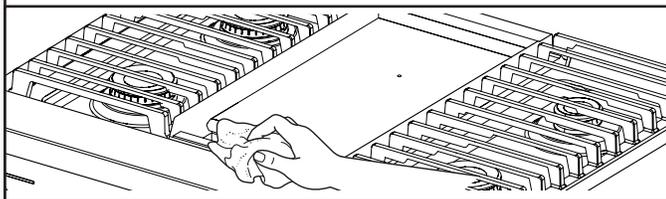
Nettoyer le plateau d'égouttement avec de l'eau tiède savonneuse. Essuyer la zone sous le plateau d'égouttement. Une fois sec, replacer le plateau d'égouttement.
