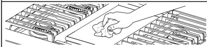
Une fois refroidie, essuyer la plaque à frire avec un linge en ratine humide et propre. Polir ensuite avec un tissu en microfibres. Si des rayures, un effet arc-en-ciel ou un effet flou apparaît, utiliser un mélange comportant une part de vinaigre pour 2 parts d'eau et essuyer la plaque à l'aide d'un tissu.
