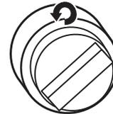
Si le brûleur ne s'allume pas, vérifier l'alignement du chapeau. Si le brûleur ne s'allume toujours pas, ne pas réparer vous-même le brûleur scellé. Contacter un technicien de réparation qualifié.
