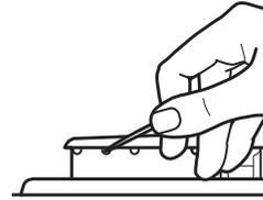
Utiliser une épingle droite. Ne pas agrandir ni déformer l'orifice. Ne pas utiliser un cure-dents en bois. Si le brûleur a besoin d'être ajusté, contacter un technicien de réparation qualifié.
