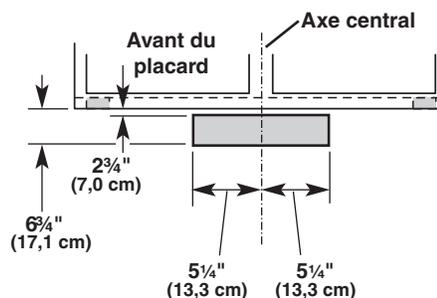
3. Soulever la hotte sous le placard et déterminer sa position d'installation finale en la centrant sous le placard. Sur la face inférieure du placard, marquer l'emplacement des 4 trous de montage sur la hotte. Placer la hotte à part sur une surface couverte.
