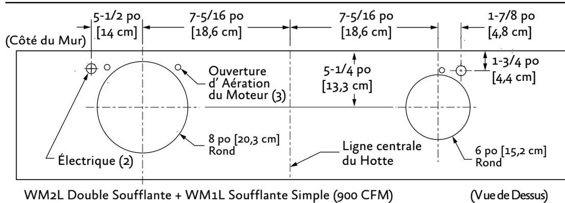
Schéma de Connexion 54 po [137,2 cm] de largeur
