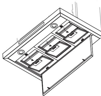
6. Fixez l'ensemble de couvert inférieur à la hotte à l'aide des vis 4 x 15 mm et 4,5 x 13 mm comme indiqué sur le schéma ci-dessous pour fixer le panneau. Serrez pour sécuriser.
