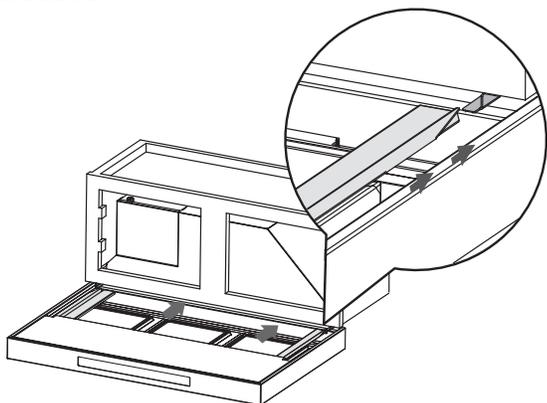
5. Ouvrez le panneau périphérique et retirez les filtres à graisse métallique de l'ensemble inférieur de la canopée.
