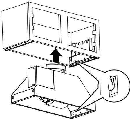
2. Fixez les vis de 4,2 x 8 mm (8) dans les ouvertures à fentes. Ne pas complètement serrer les vis.
