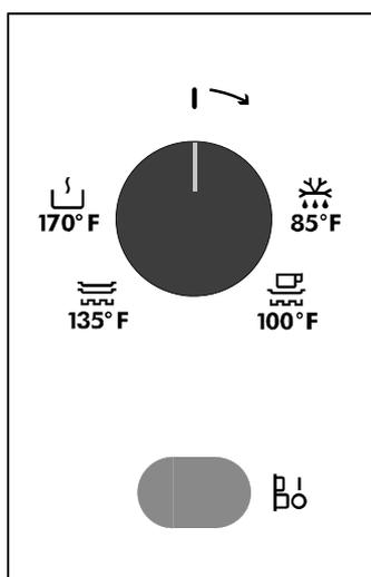
Le tableau de commandes comporte un sélecteur de fonction et un bouton marche/arrêt. Le tableau de commandes n'est visible que lorsque le tiroir est ouvert.
