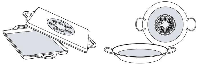
Les fonds de récipients ayant des composants en aluminium réduisent la surface ferromagnétique. Cela peut réduire la puissance de sortie et les récipients ne sont qu'insuffisamment ou pas du tout détectés, et donc pas suffisamment chauffés.
