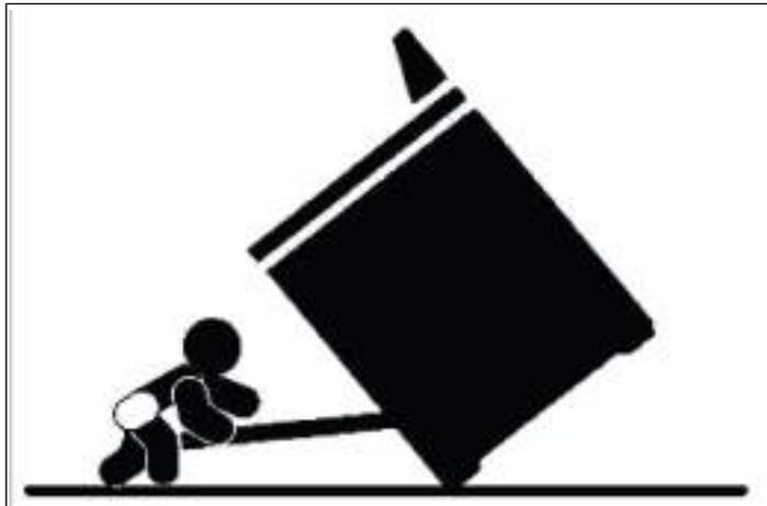
Pour réduire le risque de basculement de l'appareil, celui-ci doit être fixé au moyen de dispositifs anti-basculement, conformément aux instructions d'installation. Remettre en place le dispositif anti-basculement après tout déplacement de la cuisinière.
