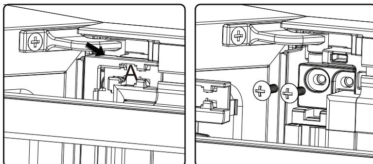
2. Retirez le capuchon en plastique noir, marqué A, dans le coin supérieur droit de la porte et le capuchon, marqué B, dans le coin inférieur droit. Retirez les 2 vis des charnières supérieure et inférieure.
