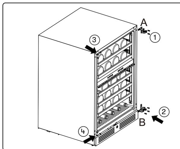
4. Dévissez les 6 vis des charnières 1 et 2 et les 6 clous décoratifs noirs de 3 et 4 sur le corps de l'appareil. Réinstallez la charnière, marquée A, dans le coin inférieur gauche. Réinstallez la charnière, marquée B, dans le coin supérieur gauche. Ensuite, réinstallez les 6 clous décoratifs noirs sur le côté droit.
