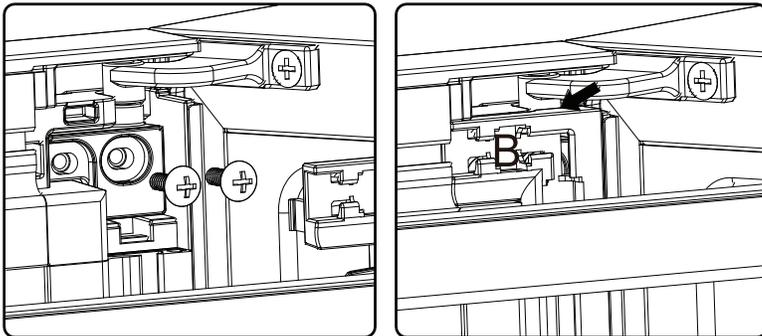
7. Une fois la porte alignée, serrez les 2 vis retirées à l'étape 2 dans les coins supérieur et inférieur et placez le capuchon en plastique noir, marqué A, dans le coin inférieur gauche et le capuchon, marqué B, dans le coin supérieur gauche.
