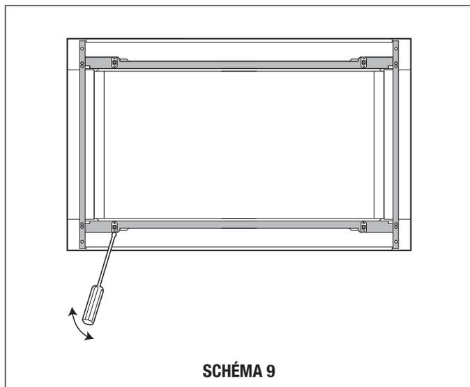
E. INSTALLATION DU CADRE ARRIÈRE : Placer le cadre arrière à distances égales de haut en bas et de chaque côté. Tracer l'emplacement de quatre (4) trous au centre à l'aide d'un poinçon et prépercer à l'aide d'une mèche de 1,45 mm (1/16 po). Fixer le cadre à l'aide de quatre (4) VIS (G). Voir schéma 10.
