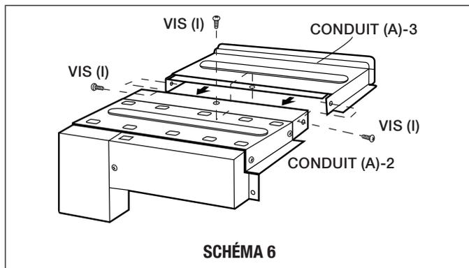
E. Retirer la VIS des coins supérieurs droit et gauche à l'arrière du four. Placer l'ensemble conduit au-dessus de l'appareil comme illustré et fixer l'ensemble conduit sur le four à l'aide des deux vis qui viennent d'être retirées. Voir schéma 6A.
