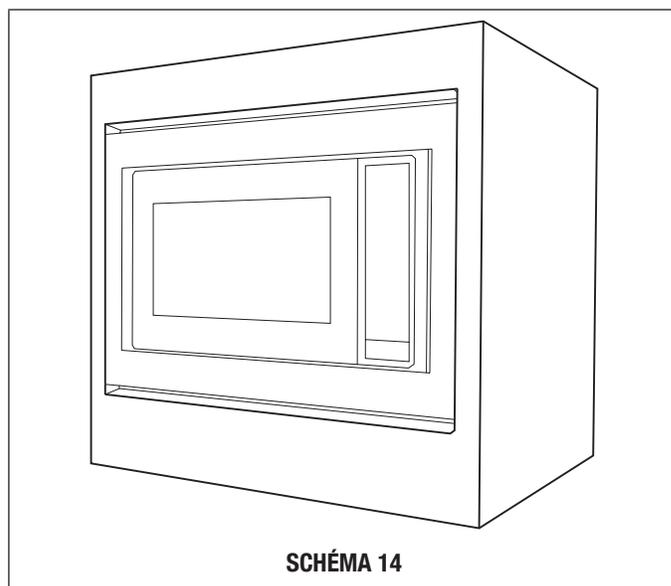
F. INSTALLATION DU CADRE AVANT : Placez le CADRE AVANT sur le CADRE ARRIÈRE et alignez les pivots à rotule et les récepteurs. Fixez le CADRE AVANT au CADRE ARRIÈRE en appuyant fermement sur le CADRE AVANT sur le CADRE ARRIÈRE en enclenchant les 4 fixations à pression. Consultez les schéma 13-14.
