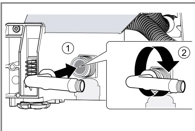
4. Acoplar la línea de agua caliente en el racor en codo. Utilizar dos llaves para apretar, usando una para estabilizar y evitar esfuerzos sobre la válvula de entrada de agua.
