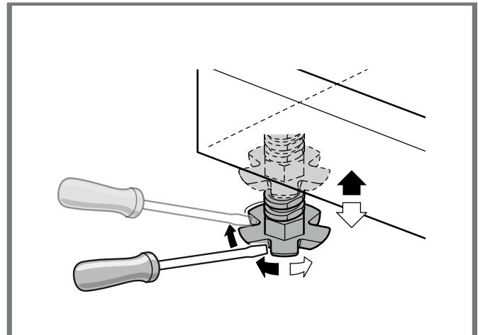
2. Utilizar un nivel para comprobar si el lavavajillas está nivelado. Comprobar que la encimera esté nivelada y ajustar el lavavajillas a la encimera.
