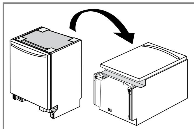
2. ①Retirez la plinthe de l'avant de l'appareil (réservez-la pour plus tard) et ② desserrez légèrement les pieds.
