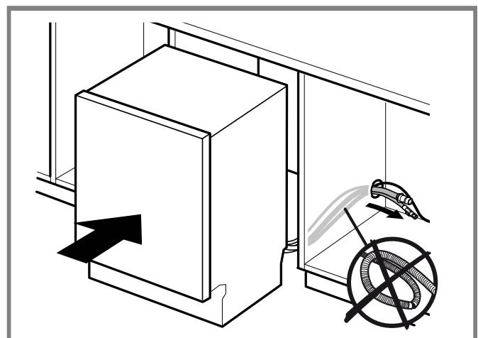
3. Tirez les tuyaux et le cordon d'alimentation à travers le trou dans l'armoire comme indiqué.
