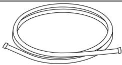
Tuyau d'arrivée d'eau - tube en cuivre de 3/8 po de diamètre extérieur minimum ou conduite d'alimentation du lave-vaisselle à tresse métallique.
