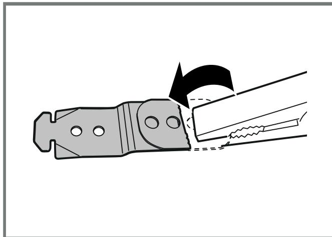
1. Agarrar el soporte de montaje con las pinzas y doblar el soporte sobre sí mismo en la perforación.
