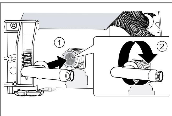
4. Reliez la conduite d'eau chaude au coude. Utilisez deux clés pour serrer, en en utilisant une pour stabiliser et évitez de mettre sous tension la vanne d'arrivée d'eau.
