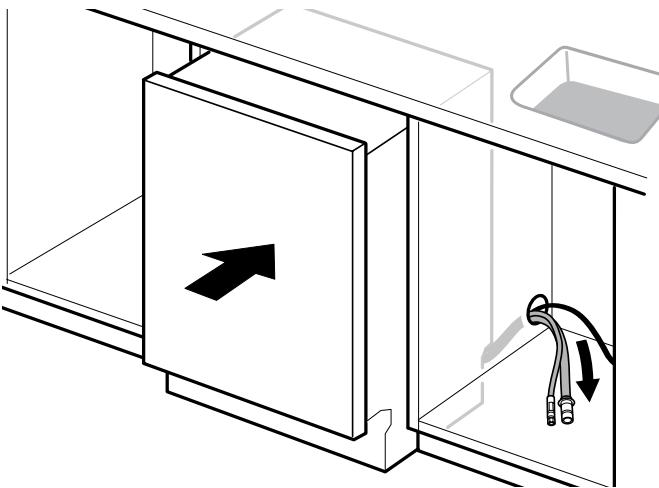
5. Dentro del gabinete adyacente, tirar de las mangueras y del cable de alimentación sobrante completamente de forma que no se tuerzan.
