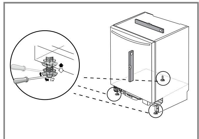
La hauteur maximale à laquelle l'unité peut être élevée est de 867,3 mm (34,5 po)
