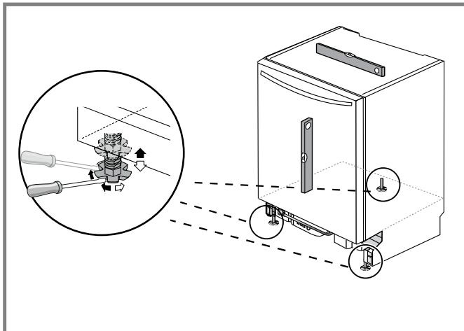
La unidad puede elevarse hasta una altura máxima de 34,5" (867,3 mm)
