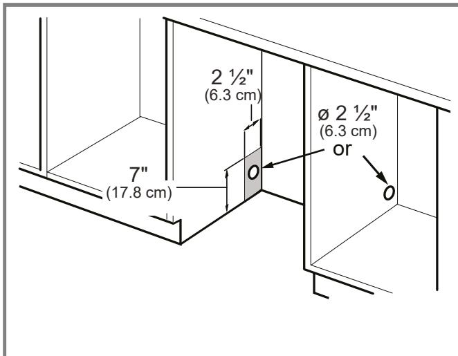
Si l'ouverture est pratiquée à travers le bois, sablez-la. Si l'ouverture est pratiquée à travers du métal, utilisez la trousse de protection des bords avec clips pour cordon d'alimentation SMZEPCC1UC.
