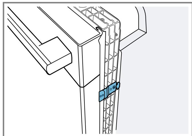
2. Acoplar los soportes de montaje al bastidor con los tornillos de 3/4" (19 mm) suministrados.
