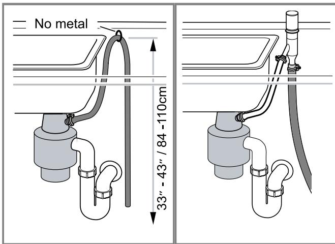
3. Si no tiene una eliminación de residuos, conecte la manguera de desagüe a la conexión de desagüe con un bucle alto o una separación para ventilación.
