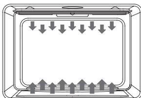
**REMARQUE :** L'élément inférieur est dissimulé sous le fond du four.
