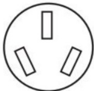
Tomacorriente de 3 hilos (10-50R)
