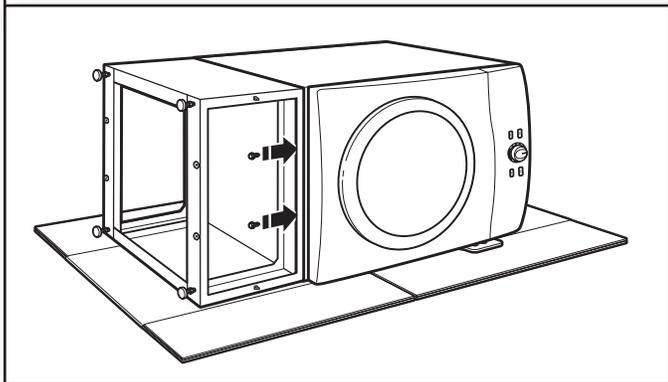
Positionner le piédestal vers l'avant de la sécheuse et installer les deux vis de tôle à tête hexagonale restantes. Ne pas visser complètement. Passer maintenant à "Achever l'installation du piédestal".
