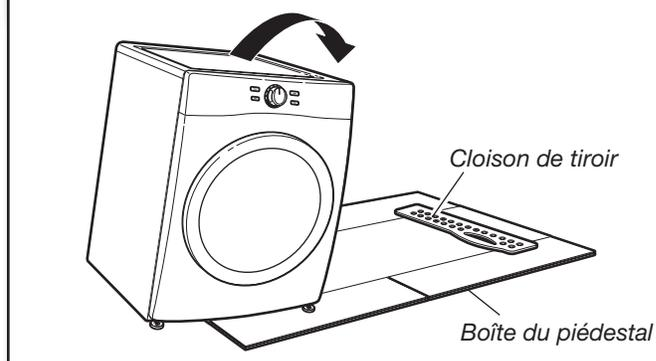
Pour éviter d'endommager le plancher et pour faciliter l'installation et la manipulation, déplier et aplatir la boîte du piédestal et la placer à proximité de la sécheuse. Positionner la cloison de tiroir de façon à ce qu'elle se trouve à proximité du dessus de la sécheuse, tel qu'indiqué. Mettre la sécheuse sur le côté avec précaution de façon à ce qu'elle repose sur la cloison de tiroir.
