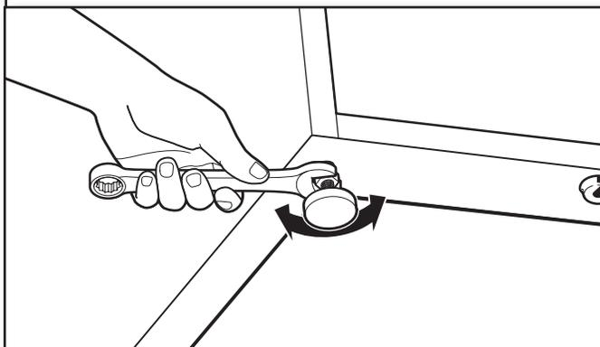
Une fois la laveuse ou la sécheuse d'aplomb et les quatre pieds sont bien en contact avec le plancher, utiliser une clé plate de 9/16" pour fixer solidement les quatre contre-écrous contre le piédestal.
