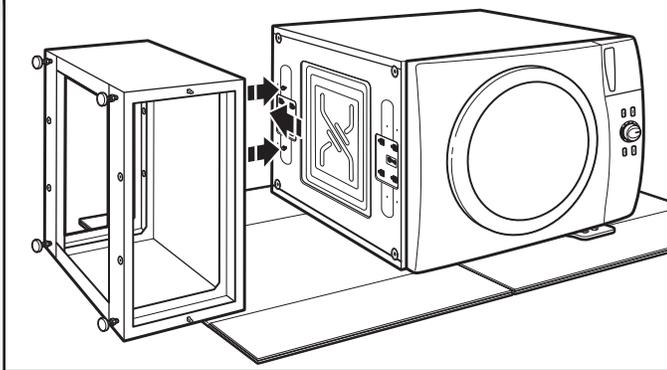
Placer le piédestal contre le fond de la laveuse. L'avant de la caisse du piédestal doit être aligné avec la caisse de la laveuse, tel qu'illustré ci-dessous.
