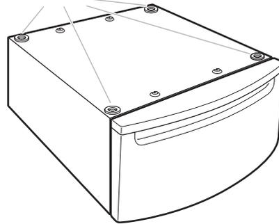
Les quatre cales d'espacement sont installées sur le dessus du piédestal. Les cales réduisent les vibrations entre le piédestal et la laveuse/sécheuse.
