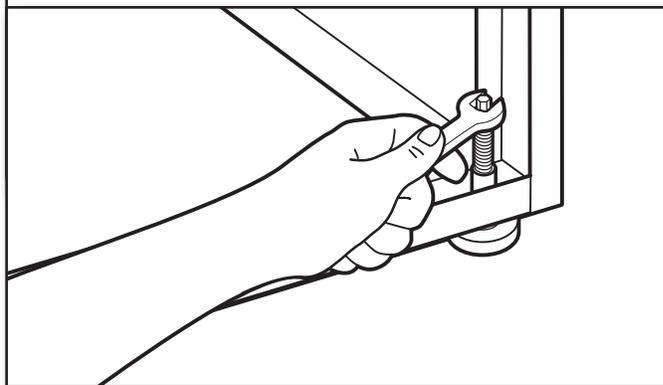
Insérer les vis de 1/4" à tête hexagonale en haut de chaque pied du piédestal. Atteindre l'intérieur du piédestal et utiliser un cliquet de 1/4" à tête hexagonale ou une clé plate pour ajuster les pieds vers le haut ou vers le bas de façon à établir l'aplomb de la laveuse ou de la sécheuse.
