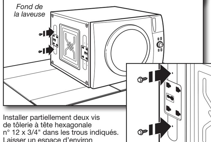
Installer partiellement deux vis de tôle à tête hexagonale n° 12 x 3/4" dans les trous indiqués. Laisser un espace d'environ 3/8" (10 mm) entre la tête des vis et le fond de la laveuse.
