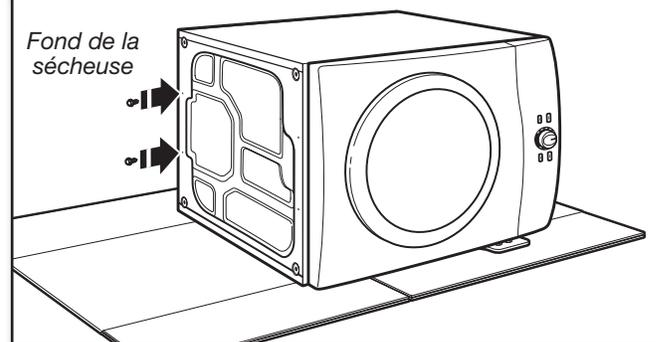
Installer partiellement deux vis de tôle à tête hexagonale n° 12 x 3/4" dans les trous indiqués. Laisser un espace d'environ 3/8" (10 mm) entre la tête des vis et le fond de la sécheuse.
