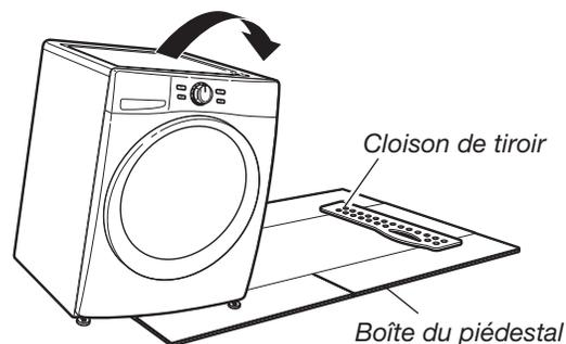
Pour éviter d'endommager le plancher et pour faciliter l'installation et la manipulation, déplier et aplatir la boîte du piédestal et la placer à proximité de la laveuse. Positionner la cloison de tiroir de façon à ce qu'elle se trouve à proximité du dessus de la laveuse, tel qu'indiqué. Mettre la laveuse sur le côté avec précaution de façon à ce qu'elle repose sur la cloison de tiroir.
