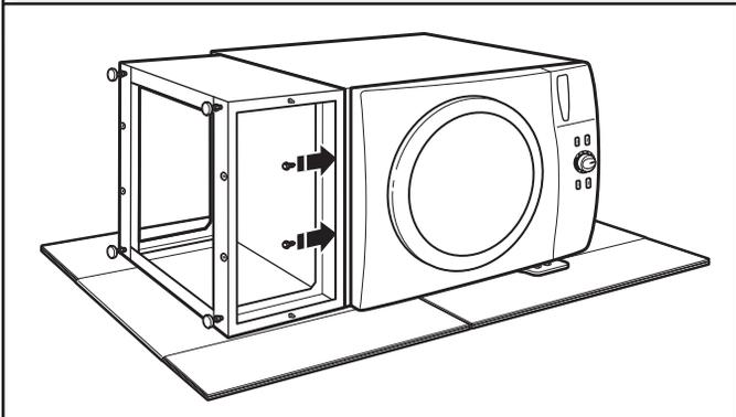
Positionner le piédestal vers l'avant de la laveuse et installer les deux vis de tôle à tête hexagonale restantes. Ne pas visser complètement. Passer maintenant à "Achever l'installation du piédestal".
