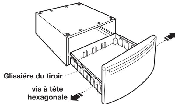
À l'aide d'un tourne-écrou de 1/4", retirer les vis à tête hexagonale des deux glissières de tiroir et conserver les vis. Retirer le tiroir des glissières et le mettre de côté. Réinsérer les glissières dans le piédestal.
