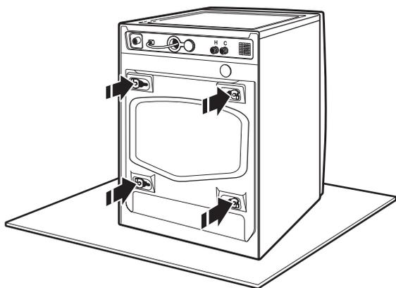
Repérer les boulons de transport à l'arrière de la laveuse. Les boulons de transport doivent rester sur la laveuse avant que le piédestal puisse être installé. Pour plus d'informations concernant les boulons de transport, voir "Élimination des accessoires de transport" dans le Guide d'utilisation et d'entretien de la laveuse.
