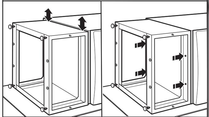
Aligner les côtés du piédestal pour qu'ils soient de niveau avec les côtés de la laveuse/sécheuse. Atteindre l'intérieur de l'ouverture du piédestal et serrer solidement les quatre vis du piédestal.
