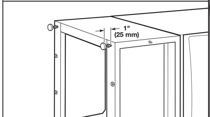
À l'aide d'un cliquet à tête hexagonale de 1/4" ou d'une clé plate, abaisser les pieds jusqu'à environ 1" (25 mm) du bas du piédestal.
