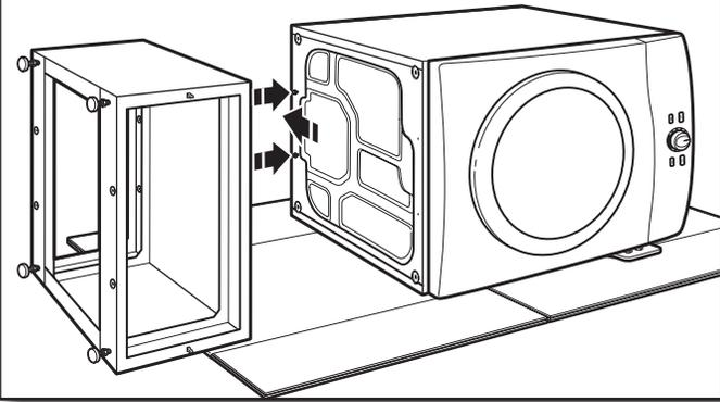
Placer le piédestal contre le fond de la sécheuse. L'avant de la caisse du piédestal doit être aligné avec la caisse de la sécheuse, tel qu'illustré ci-dessous.
