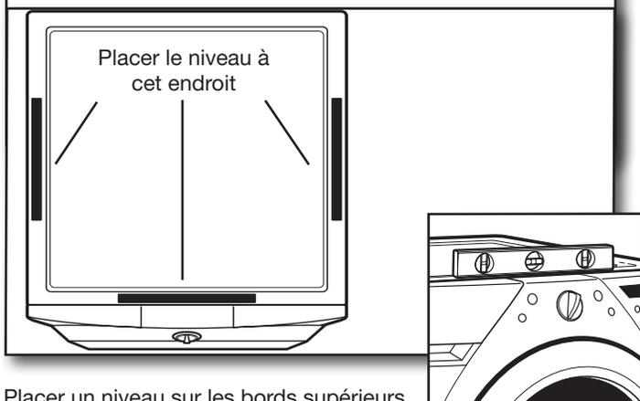
Placer un niveau sur les bords supérieurs de la laveuse/sécheuse en contrôlant chaque côté et l'avant. Faire bouger la laveuse/sécheuse d'avant en arrière pour s'assurer que les quatre pieds sont bien en contact avec le plancher.
