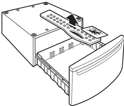
Ouvrir le tiroir du piédestal aussi loin que possible et vider son contenu. L'emballage contient quatre vis de tôle à tête hexagonale n° 12 x 3/4" et une cloison du tiroir.
