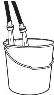
Faire couler de l'eau dans les tuyaux de l'évier de buanderie, le tuyau rigide de rejet à l'égout ou le seau pendant quelques secondes pour éviter toute obstruction. On doit laisser couler l'eau jusqu'à ce qu'elle soit limpide.
