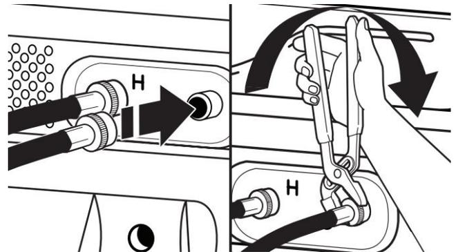
**IMPORTANT :** Pour réduire le risque de défaillance des tuyaux, remplacer les tuyaux tous les 5 ans. Inscrivez la date d'installation ou de remplacement des tuyaux pour référence ultérieure.
