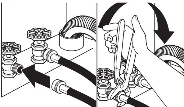
**IMPORTANT :** Ne pas serrer excessivement ni utiliser de ruban adhésif ou de dispositifs d'étanchéité lors de la fixation des robinets ou de la machine. Cela pourrait entraîner des dommages.
