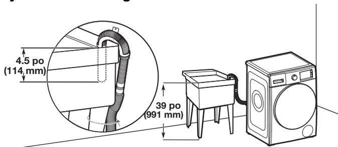
Capacité minimale : 20 gallons (76 L). Le haut de l'évier de buanderie doit être à au moins 39 po (991 mm) du sol, mais pas à plus de 48 po (1,2 m) du bas de la laveuse.
