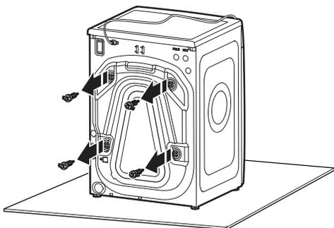
Desserrer les boulons avec une clé à molette de 5/8 po (16 mm). Glisser chaque boulon et cale au centre du trou. Retirer les boulons et cales d'espacement en plastique de l'arrière de la laveuse. Jeter les boulons et cales d'espacement.
