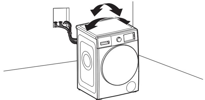
Saisir la laveuse par le dessus et la faire basculer d'avant en arrière tout en s'assurant que les quatre pieds sont en contact ferme avec le sol. Faire de nouveau basculer la laveuse transversalement. Si la laveuse bascule, passer à l'étape 15 et ajuster les pieds de nivellement. Si les quatre pieds sont en contact ferme avec le sol, passer à l'étape 16.
