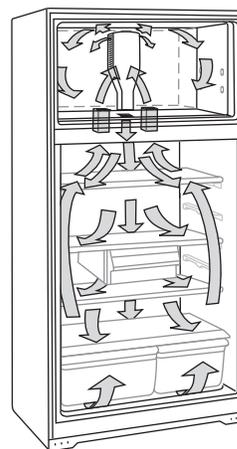
N'obstruer aucune de ces ouvertures d'aération avec des emballages d'aliments. Si les ouvertures d'aération sont bloquées, le flux d'air sera réduit et des problèmes de température et d'humidité peuvent survenir.
