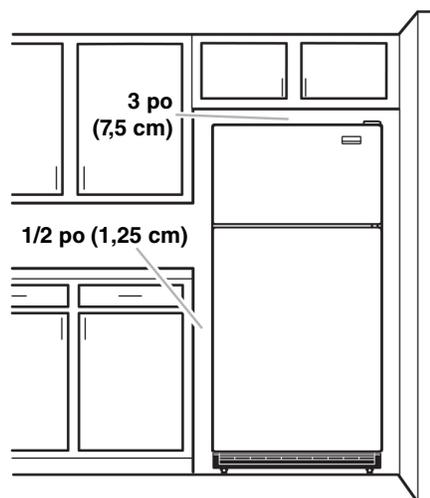
Pour obtenir une aération appropriée pour votre réfrigérateur, il est recommandé de laisser un espace de 1/2 po (1,25 cm) de chaque côté et au sommet du réfrigérateur. Laisser un espace d'au moins 1 po (2,54 cm) entre l'arrière de l'appareil et le mur (le condensateur représente l'arrière, s'il est présent). Si le réfrigérateur comporte une machine à glaçons, s'assurer de laisser un espace additionnel à l'arrière pour les raccords du conduit d'eau.
