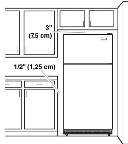
Para asegurar la adecuada ventilación para su refrigerador, se recomienda dejar un espacio de 1/2" (1,25 cm) a cada lado y en la parte de arriba del refrigerador. Deje un espacio de 1" (2,54 cm), como mínimo, entre la parte posterior del gabinete y la pared (considere el condensador como parte posterior si está presente). Si el refrigerador tiene fábrica de hielo, asegúrese de dejar espacio adicional atrás para las conexiones de la línea de agua.
