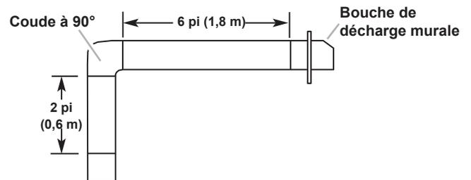
Dans l'exemple suivant, la longueur théorique du circuit est inférieure au maximum recommandé de 35 pi (10,7 m)..
