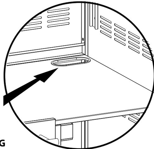
**AFTER CONNECTING THE UTILITIES AND SLIDING THE GRILL IN SO THE GRILL FLANGE IS SUPPORTED ON BOTH THE SIDES AND BACK BY THE CART PANELS -**
